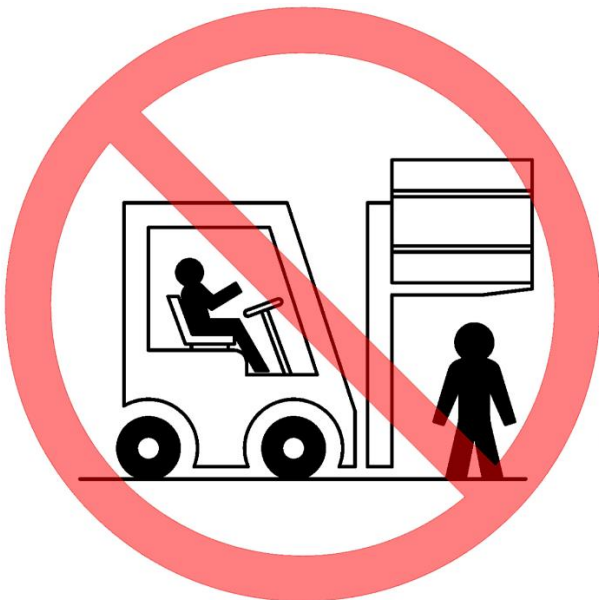
Non passare sotto il carico
