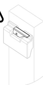
Una volta posizionata la forca, chiudere il cricchetto ferma-forca, in modo da bloccare la parte superiore della stessa.
