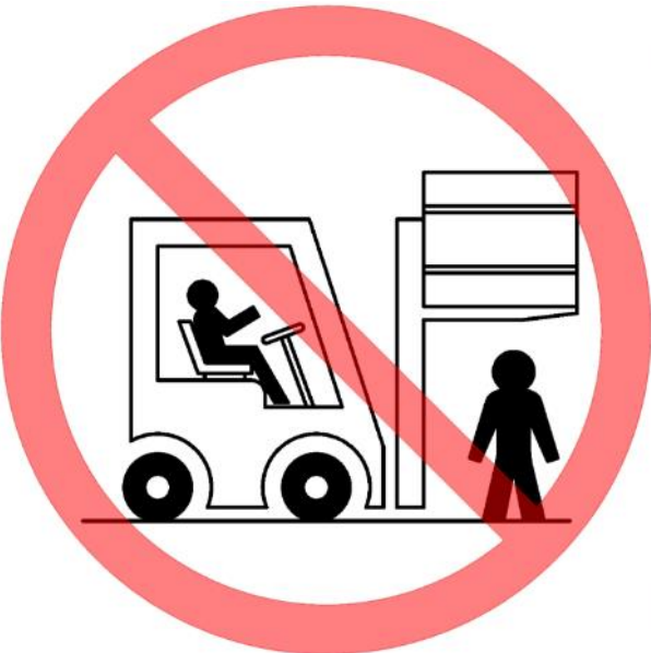
Non passare sotto il carico
