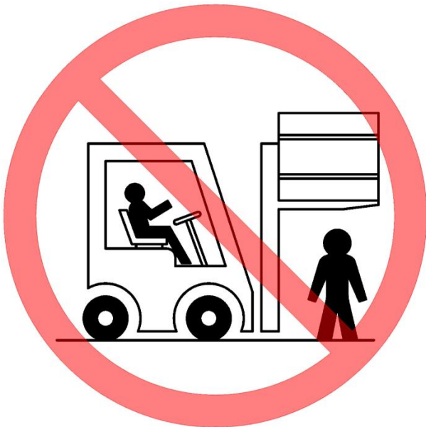
Non passare sotto il carico
