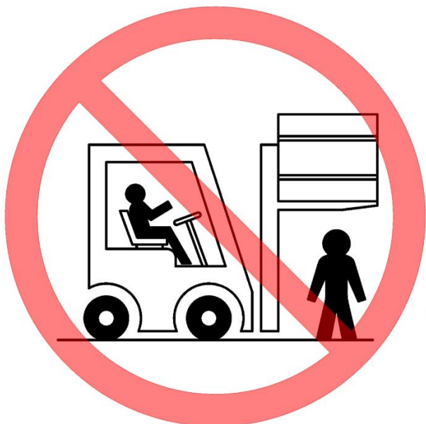
Non passare sotto il carico
