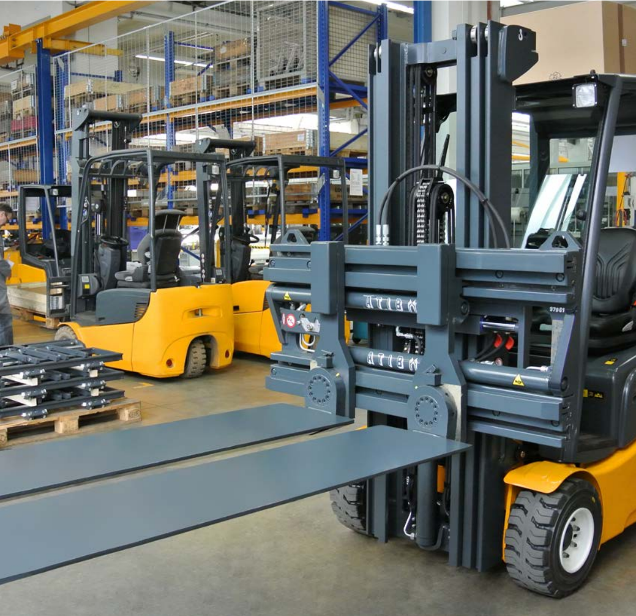
Klammer mit 90° Drehgabeln und aufsteckbaren flachen Spannarmen
