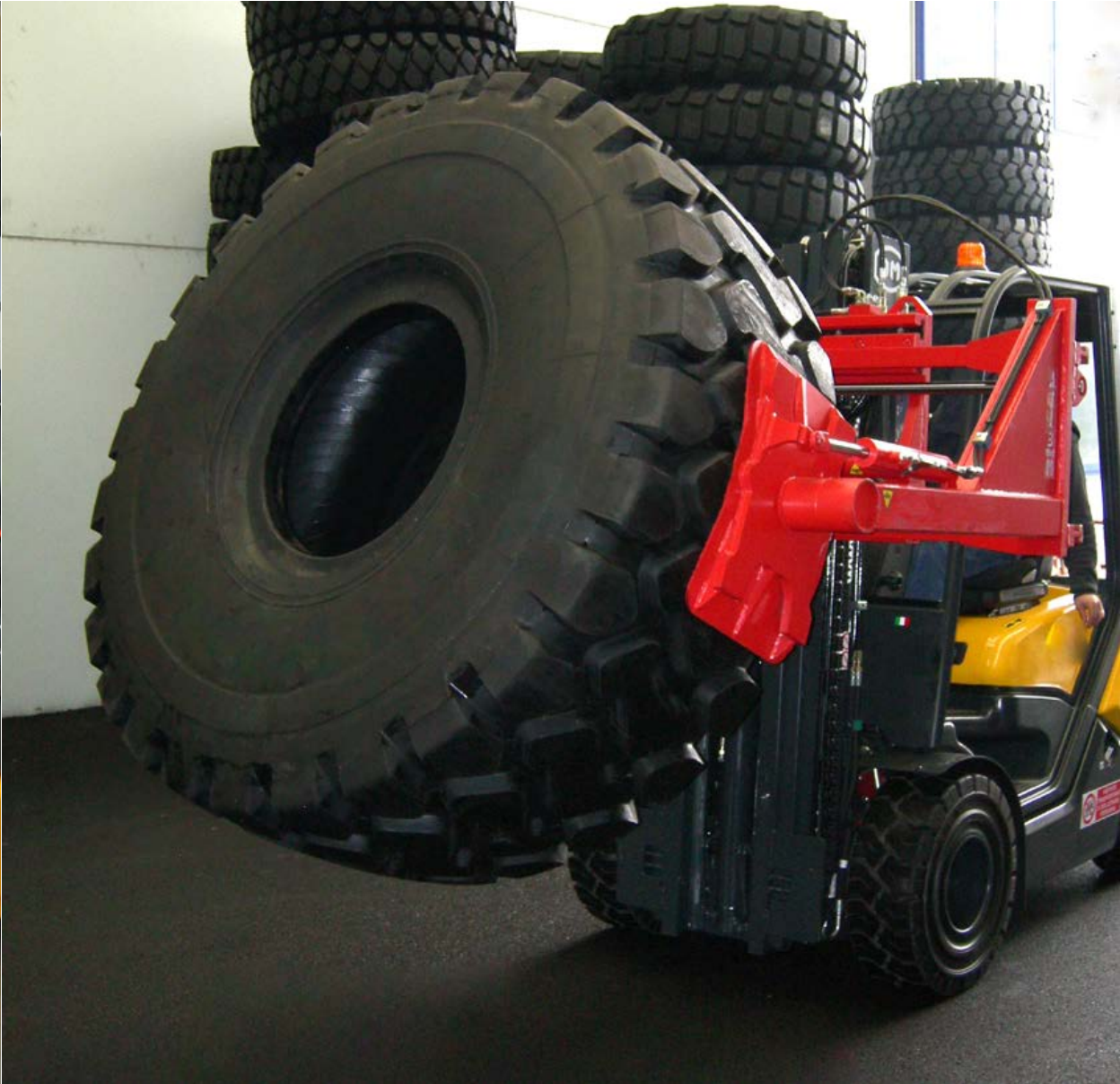
Reifenklammer mit 90° vorwärts kippbaren Druckplatten
