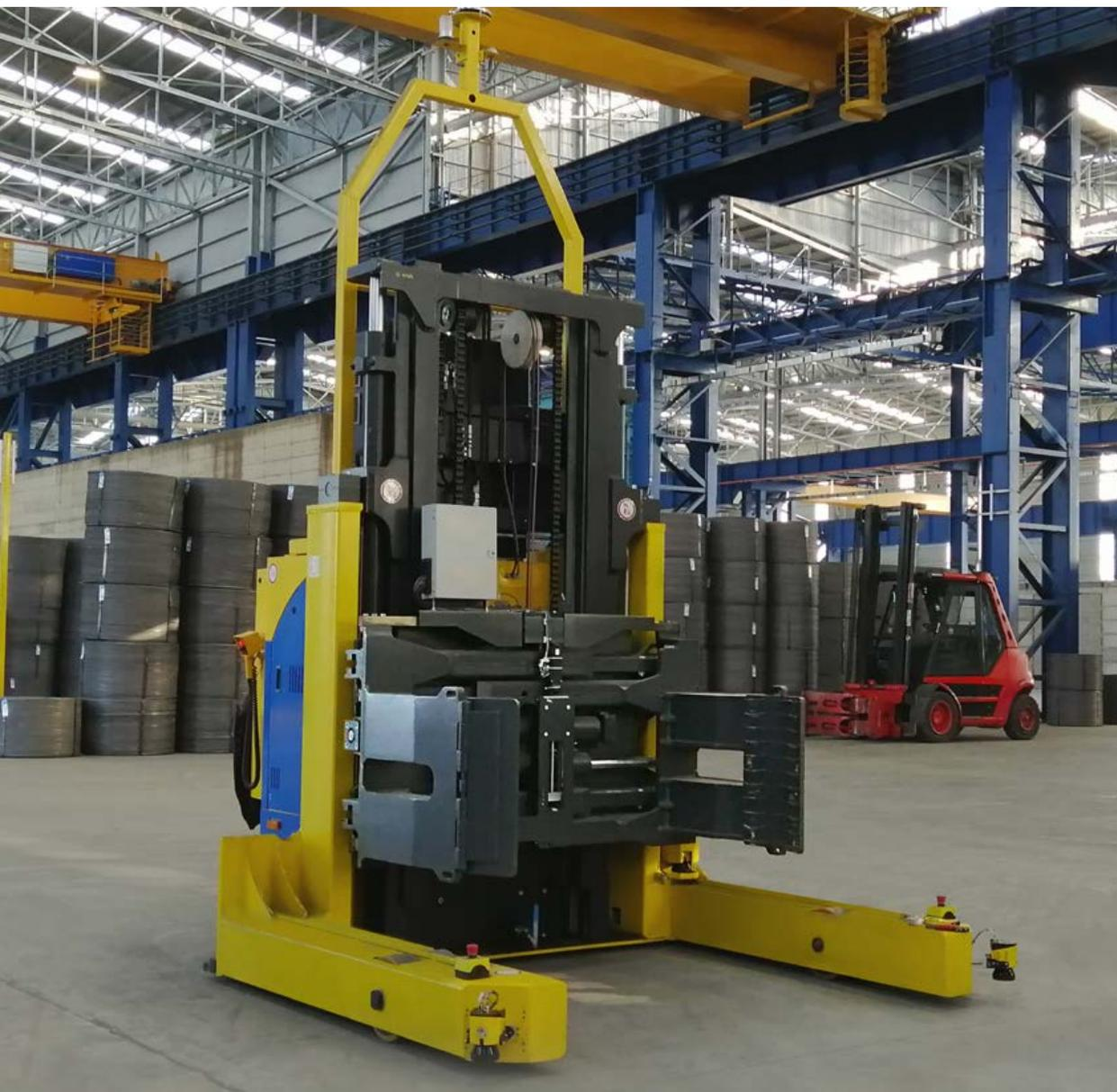
Mât Triplex avec Double Positionneurs de Fourches pour Machines AGV
