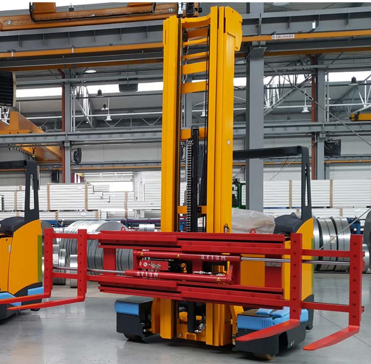
Positionneur de Fourches Intégré avec Bras Articulé pour Chariots Téléscopiques
