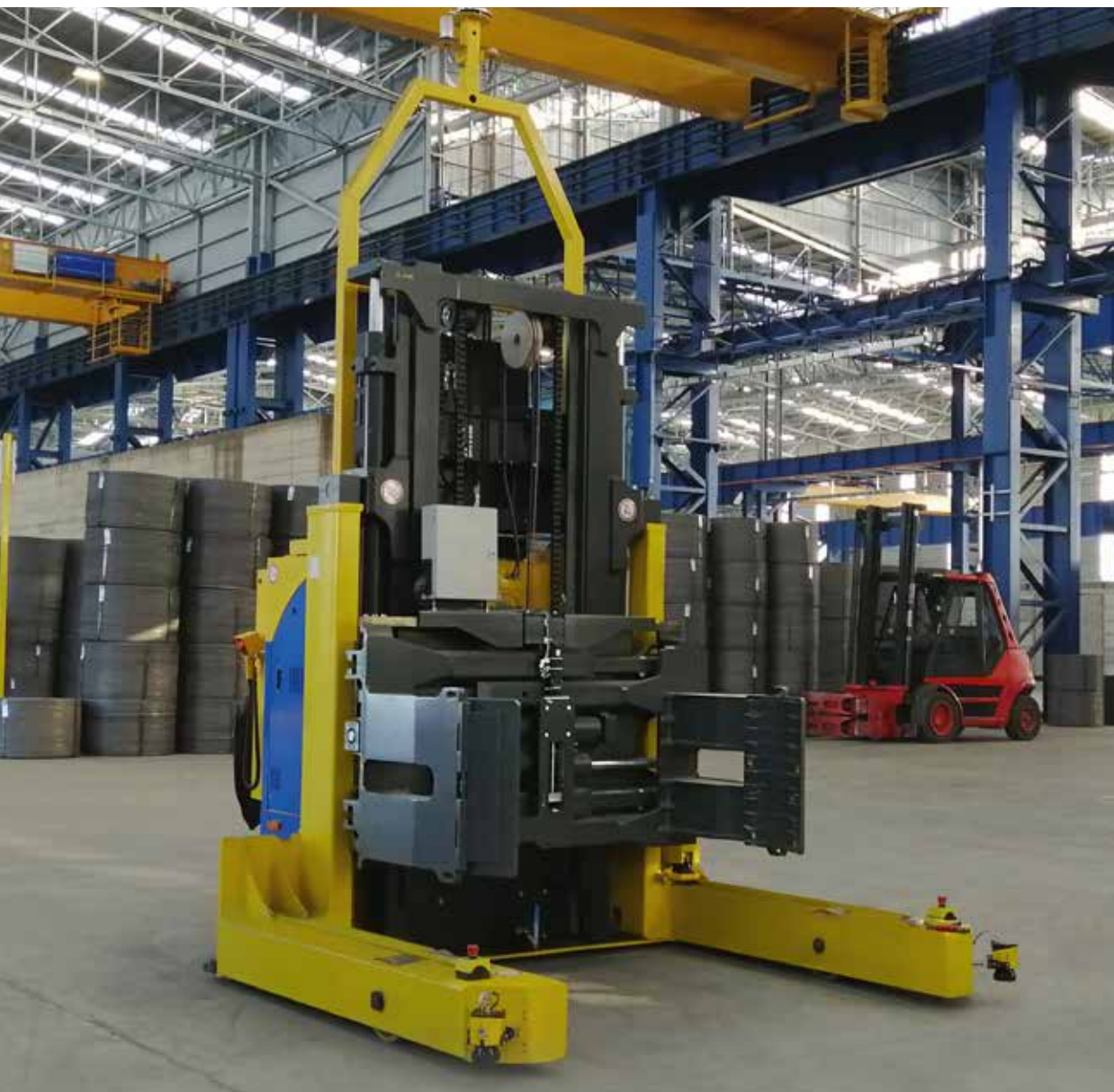
Mástil Duplex con Pinza para Bobinas para Máquinas AGV
