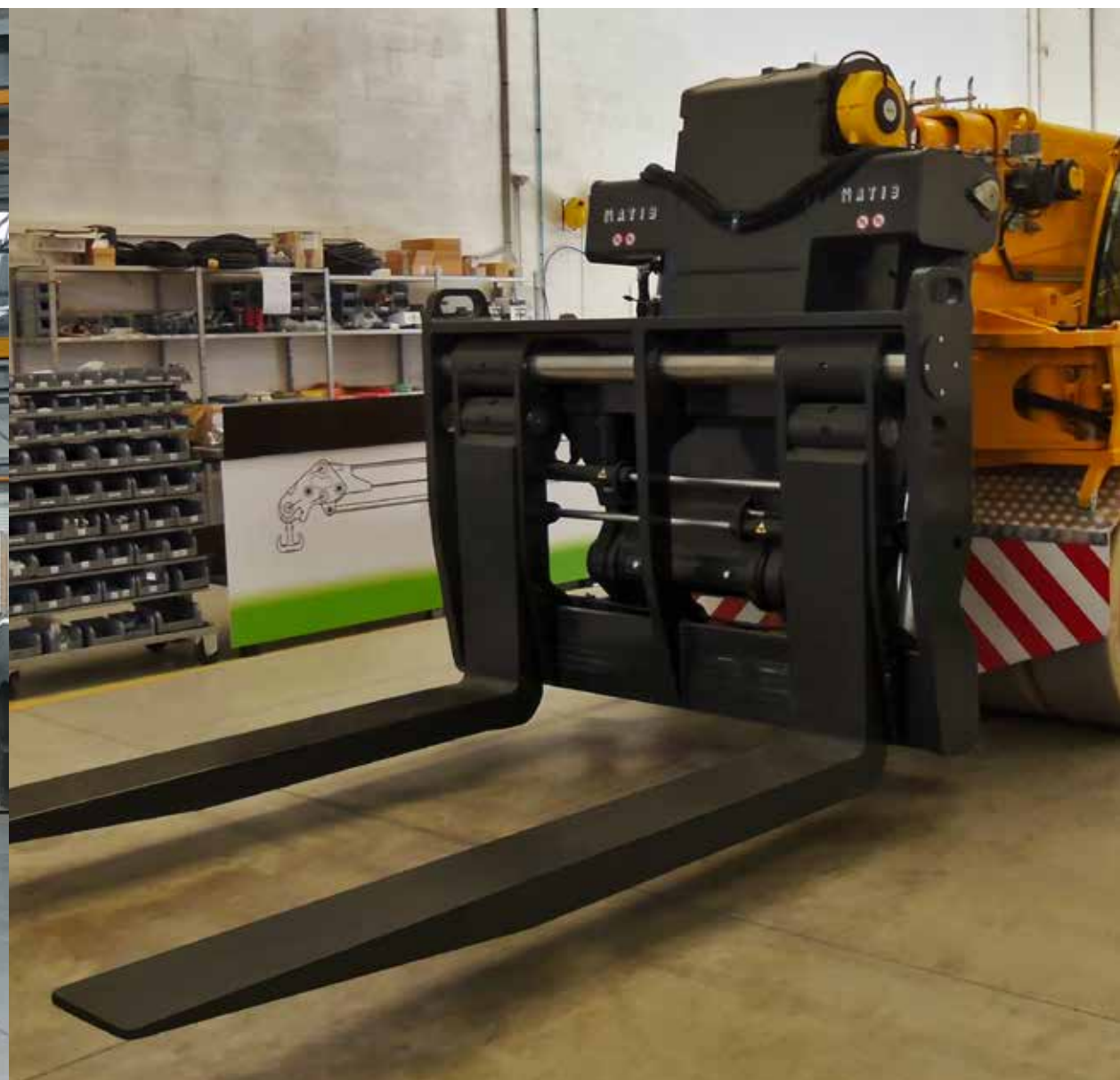
Posicionador de Horquillas Integrado con Brazo Articulado para Carretillas Telescópicas
