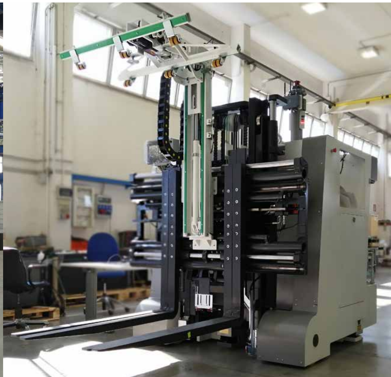
Mástil Triplex con Doble Posicionador de Horquillas para Maquinas AGV
