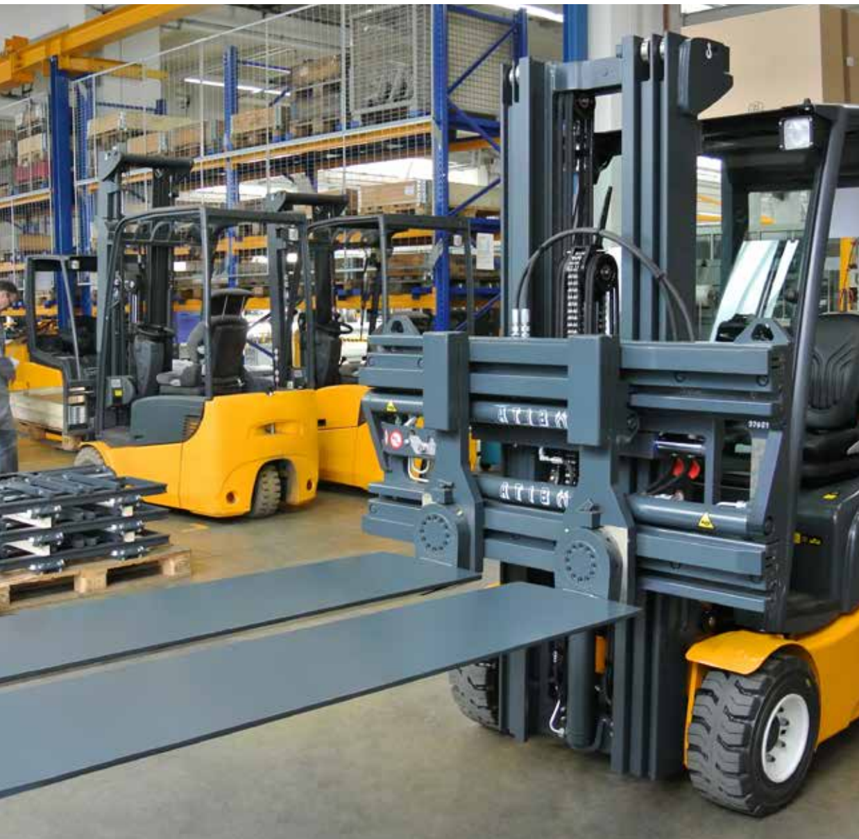
Pinza de Horquillas Pivotantes 90° con Postizos Planos y Lisos
