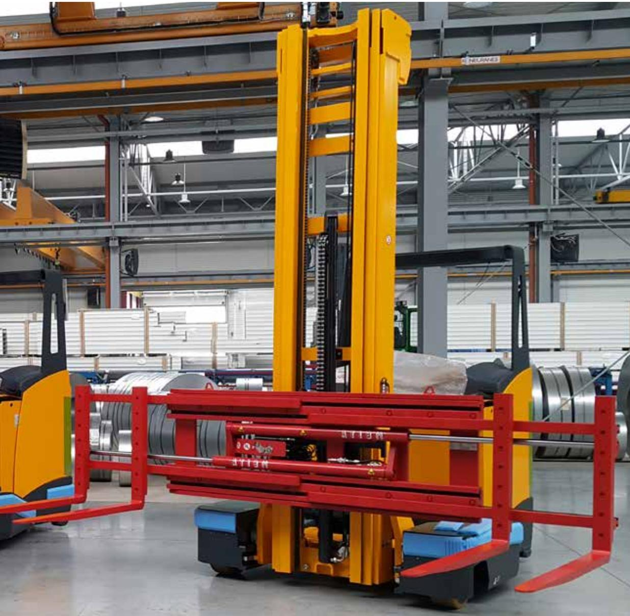
Positionneur de Fourches Intégré avec Bras Articulé pour Chariots Télescopiques
