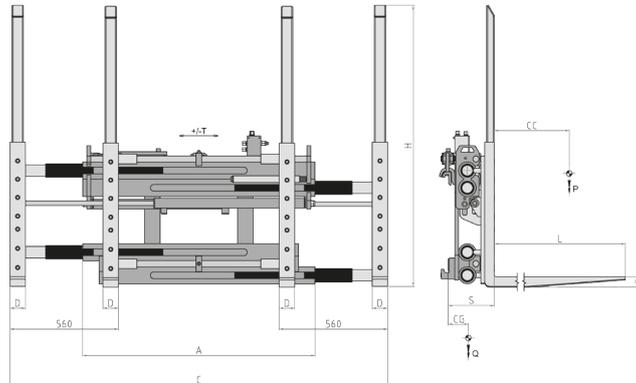
**Funciones Hidráulicas: 2 | Presión Máx de Trabajo: 200 Bar**
