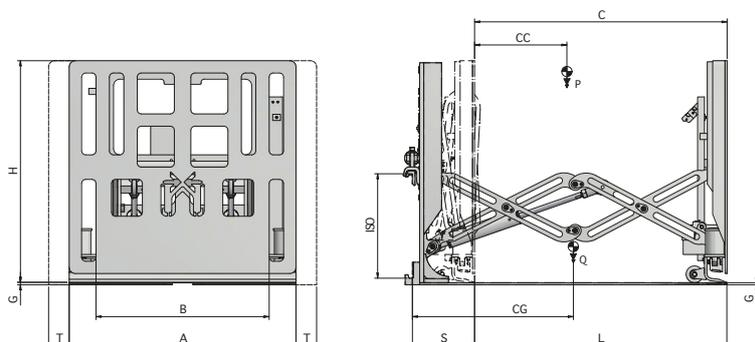
Fonctions hydrauliques: 2 + Fonctions Électrique: 1 | Pression max d'utilisation: 175 Bar
