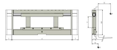
Funciones Hidráulicas: 1 | Presión Máx de Trabajo: 200 Bar
