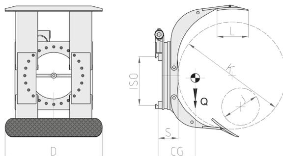
Fonctions hydrauliques: 2 | Pression max d'utilisation: 175 Bar
