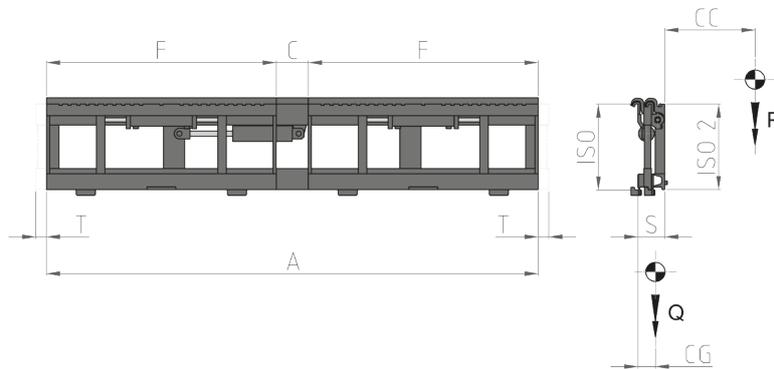
Fonctions hydrauliques: 2 | Pression max d'utilisation: 200 Bar
