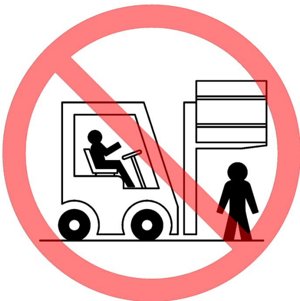
Nicht unter gehobene Lasten vorbeigehen
