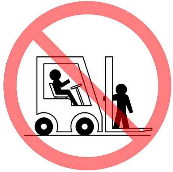
Ne pas traverser le mât
