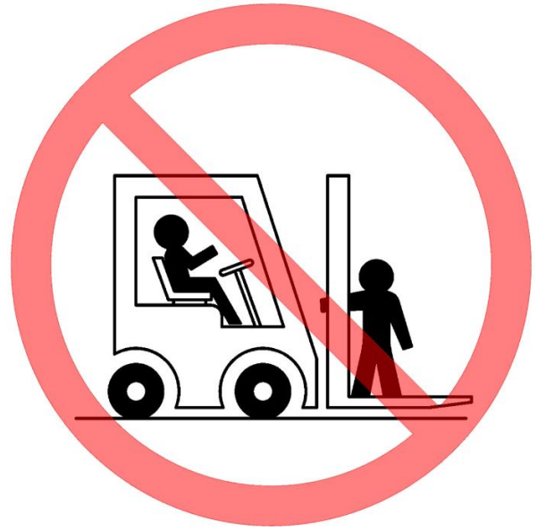
Ne pas traverser le mât
