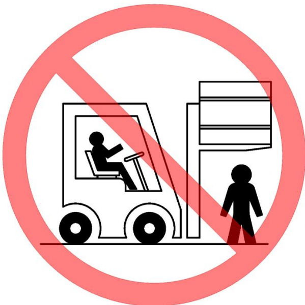
Nicht unter gehobene Lasten vorbeigehen
